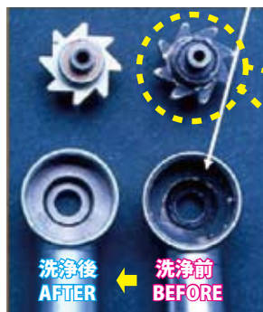
タービncカートリッジ・チャック部に付着した汚れ
